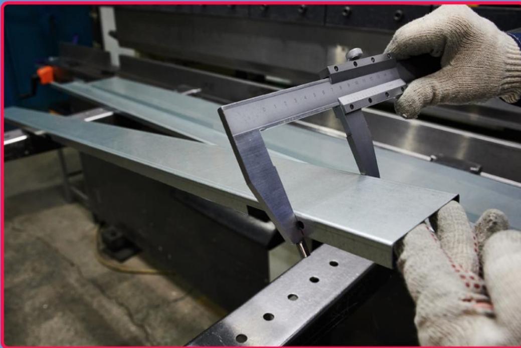
Agora você foi solicitado(a) para certificar através das medições feitas na largura - medida básica de verificação se está conforme ou não conforme - utilizando um paquímetro, obtendo 5 leituras das quais foram:
